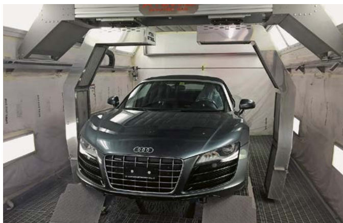
Getrocknet wird in der «kleinen» Lackierkabine mit Infrarot. Le séchage a lieu dans la «petite» cabine de peinture à infrarouge.
